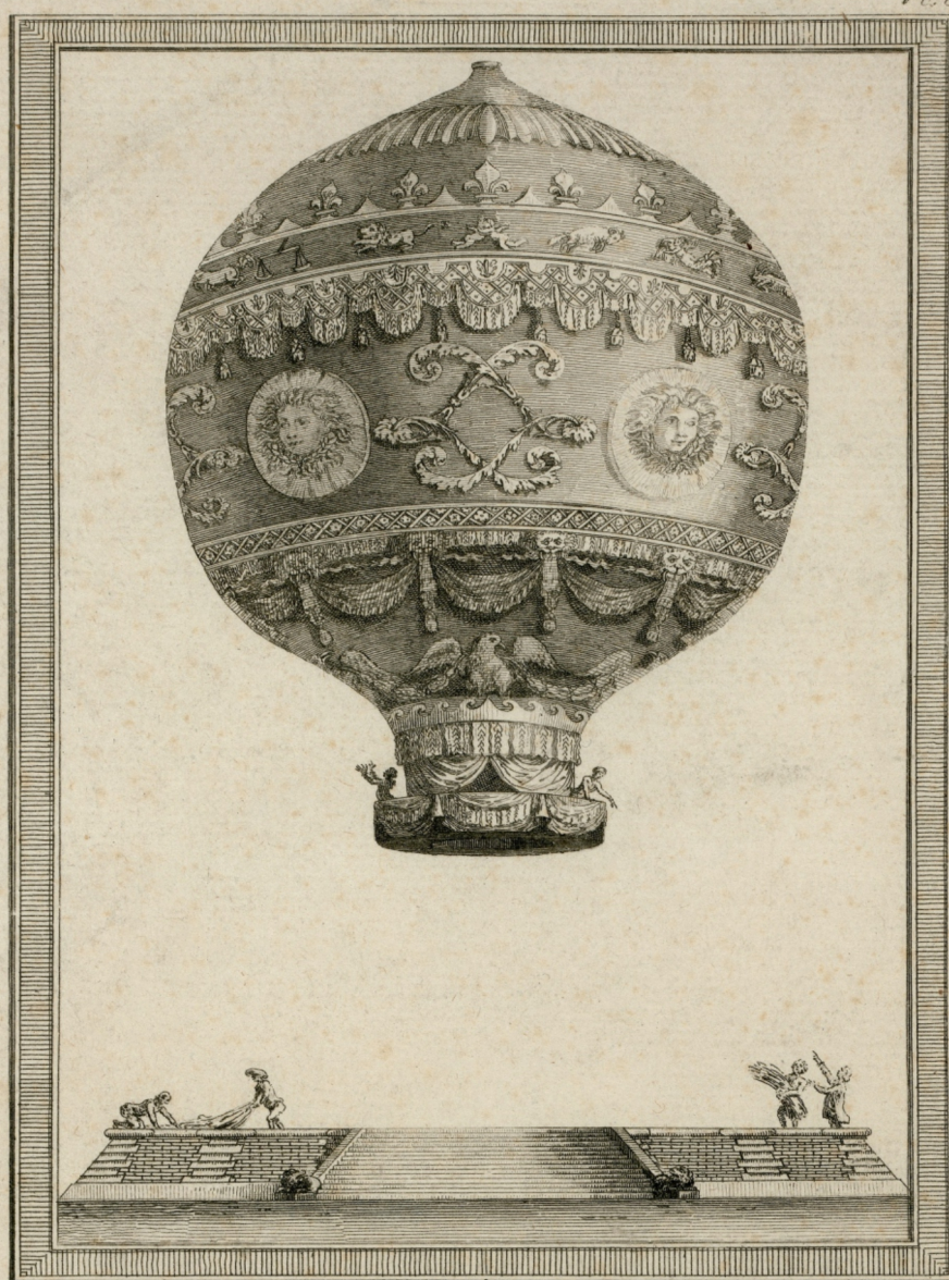
Machine Aérostatique de 70 Pieds de hauteur sur 46 de Diamètre, qui s'est élevée à Paris, avec deux hommes à la hauteur de 324 Pieds le 19. Oct. 1783.
